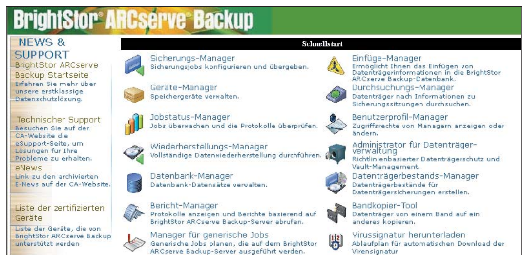
Abbildung 2. Die BrightStor ARCserve Backup-Konsole ermöglicht die zentrale Konfiguration der Backup- und Restore-Prozesse für verschiedene Plattformen.
